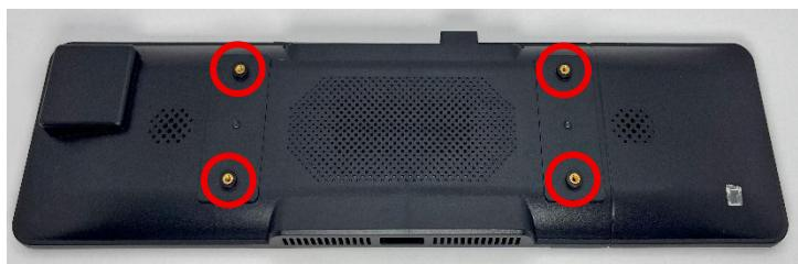
（3）先程、取り外したネジを使用し天吊りブラケットへの変換部品を取り付ける（4カ所ネジ止め）
