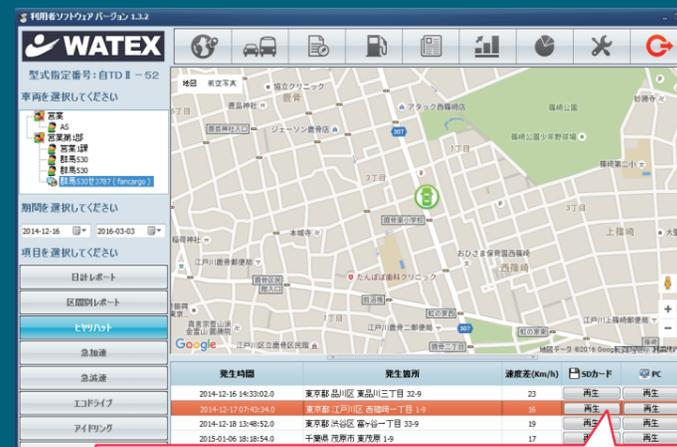
ドライブレコーダーのSDカードをパソコンに挿入し、利用者ソフトで抽出したヒヤリハットデータの再生ボタンを押すとヒヤリハット発生時間の動画を再生します。
