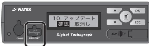
↑共通出力端子のカバーを外しUSBメモリを差し込みます。
