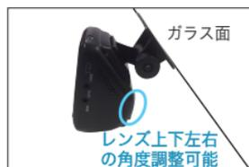
レンズの上下左右の角度を調整し、電源、リアカメラのケーブルを配線し micro SD カードを挿入する
