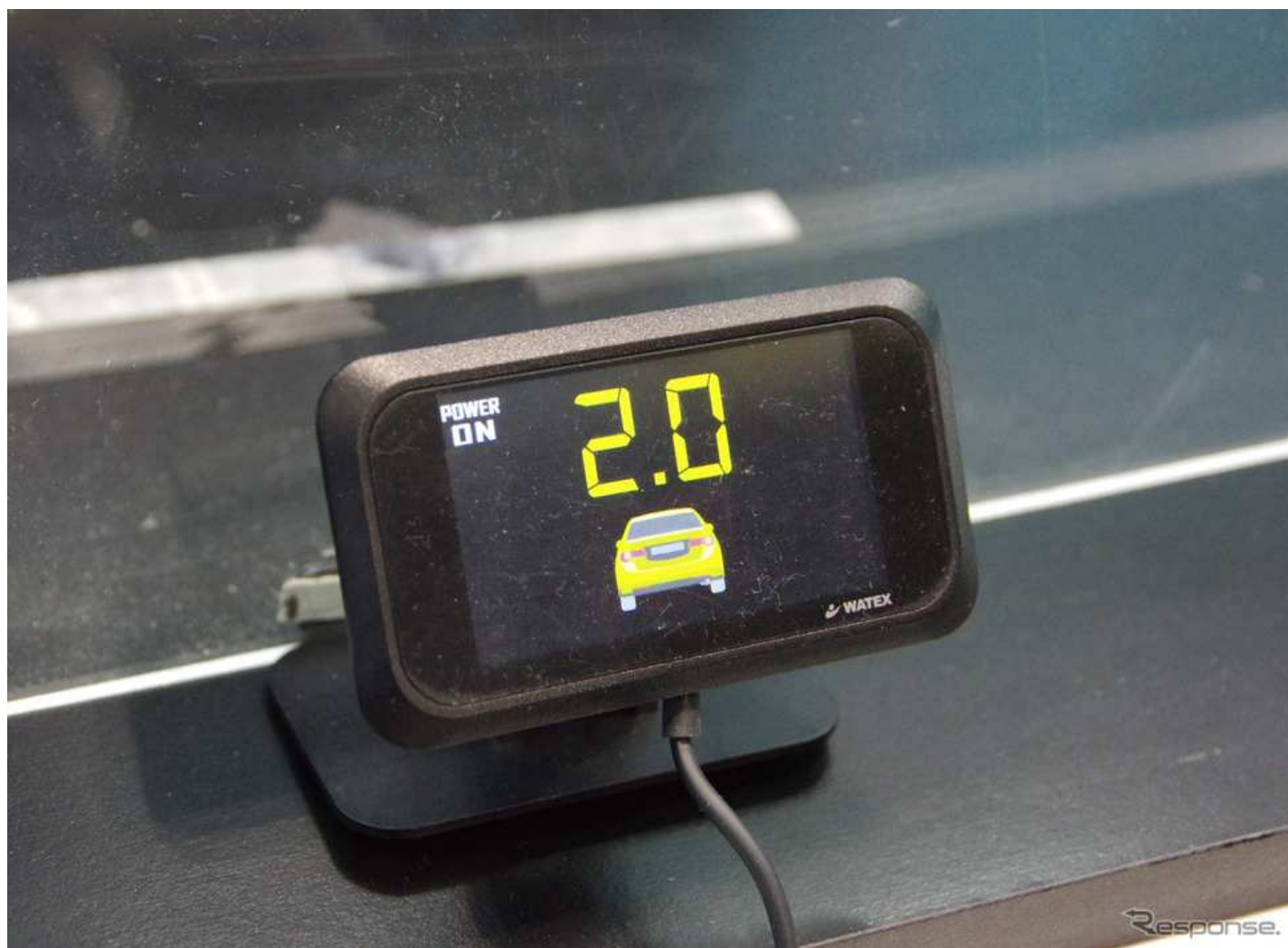
9cm程度のモニタには、前車との距離や制限速度を表示する 《撮影 宮崎壮人》
