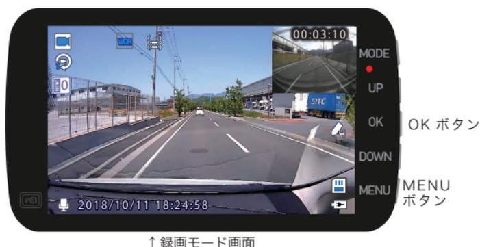
MENU ボタンを押すたびに、 録画モード設定 → 共通設定 → 元の画面 が表示されます。モードを切り替えて、静止画モード、再生モードの各設定も行えます。設定内容は次ページ参照
