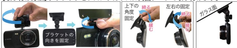
取付ブラケットのネジを挿入して右まわりに締める
