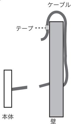
①コード類を丸穴から通し、反対側を壁上側から内側に向け、落ちないようにテープで固定してください。
