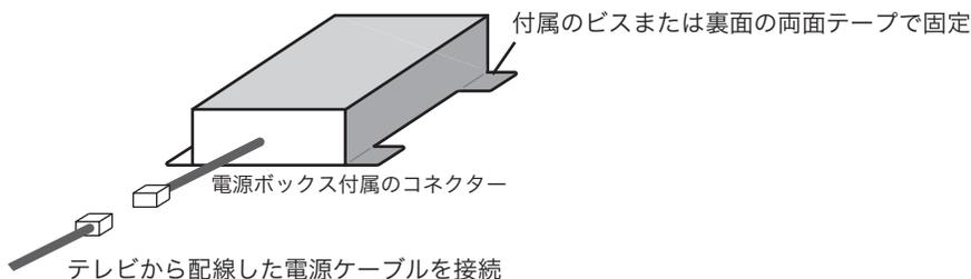
④電源ボックスを付属のビス（4ヶ所）、または裏面の両面テープで固定してください。
