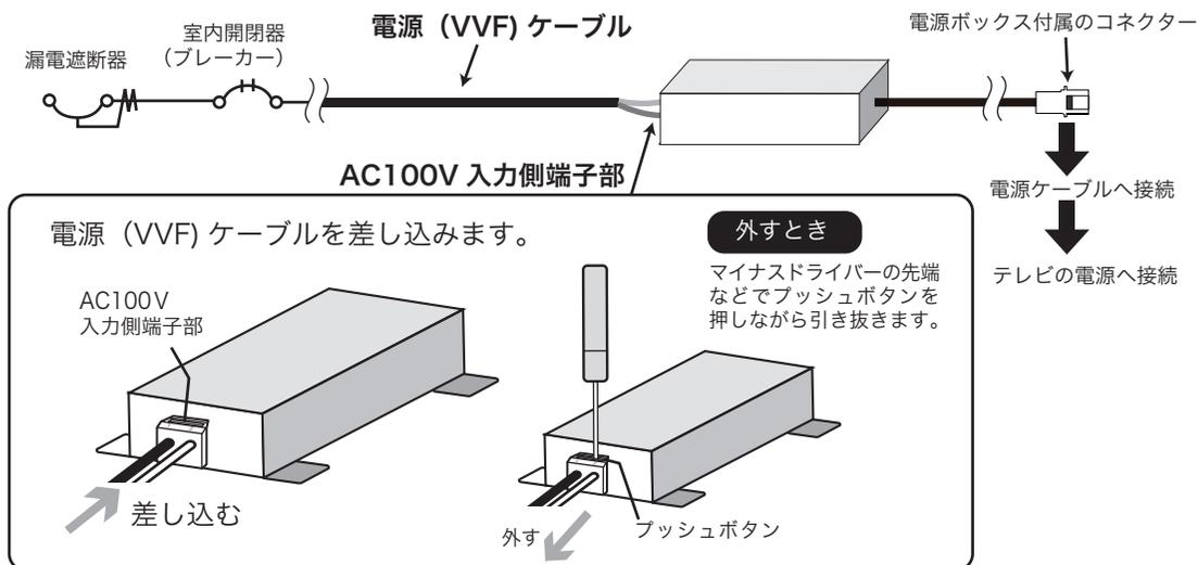
③電源ボックス付属のコネクターと配線した電源ケーブルを接続してください。
