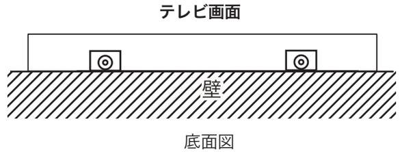
① テレビ底面にビスカバーをして、六角穴付タッピングビス(M4×10)2本を六角レンチで2箇所、固定してください。
