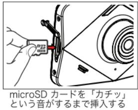
**!** microSD カードの抜き差しは、必ず電源が切れている状態で行ってください。
