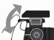
プラケットの角度調整ネジを緩めた状態で仮固定し、取付角度を調整し調整後にネジを締めてください。
