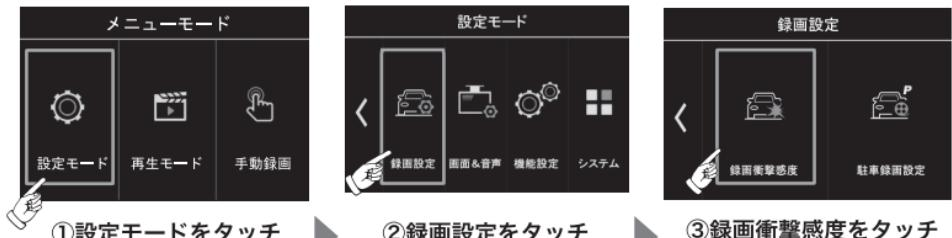
録画衝撃感度で、常時衝撃感度、駐車衝撃感度をタッチして設定します。
