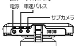
お買い上げの機種に付属している電源ケーブル、サブカメラケーブル、車速パルスケーブルなどを運転の支障にならないよう配線してください。
