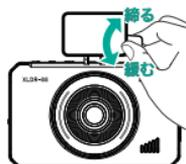
取付ブラケットの角度調整ツマミを緩めた状態で仮留め後、角度調整をし、調整後にツマミを締めます。液晶の映像を確認して本体と道路が垂直になるように角度を調整してください。
