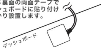
⚠ 自動車の機能 (エアバック等) の妨げにならない場所に取り付け、配線してください。事故や怪我の原因となります。ケーブルを運転の支障にならないよう配線してください。
