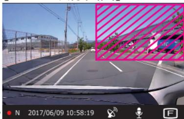
リアカメラ録画 ON に設定した時 (23ページ) 部分をタッチすると液晶に表示される画面が切り替わります。(12ページ参照)
